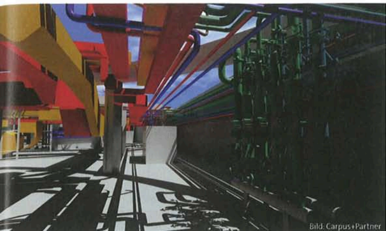
Bild 7: 3D-Modell der Kälteversorgung
